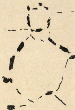
10. ábra. Kadmium fémtestben 0,1% Sn-tartalom minden újrakristályosodáskor és átkristályosodáskor a legújabb kristallithatárookra helyezkedik át, úgy amint azt az ábra egy 250 C°-os hevítés után szemlélteti (TAMMANN, G. és HEINZEL, A. [40] 150. o., 6. ábra nyomán; 1928)
