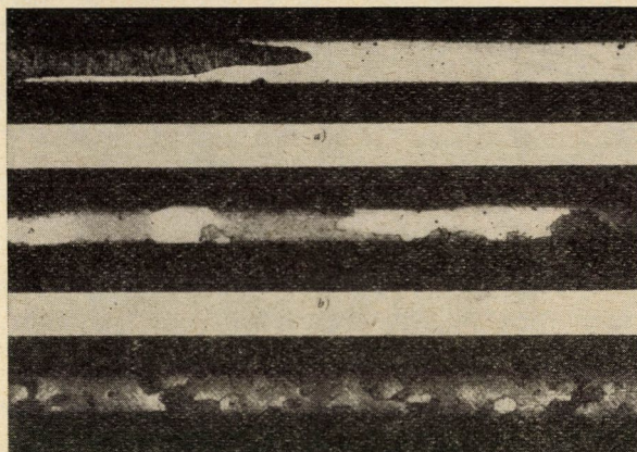
2. ábra. Húzott wolframdrótok kristályszerkezete újrakristályosodás után.
