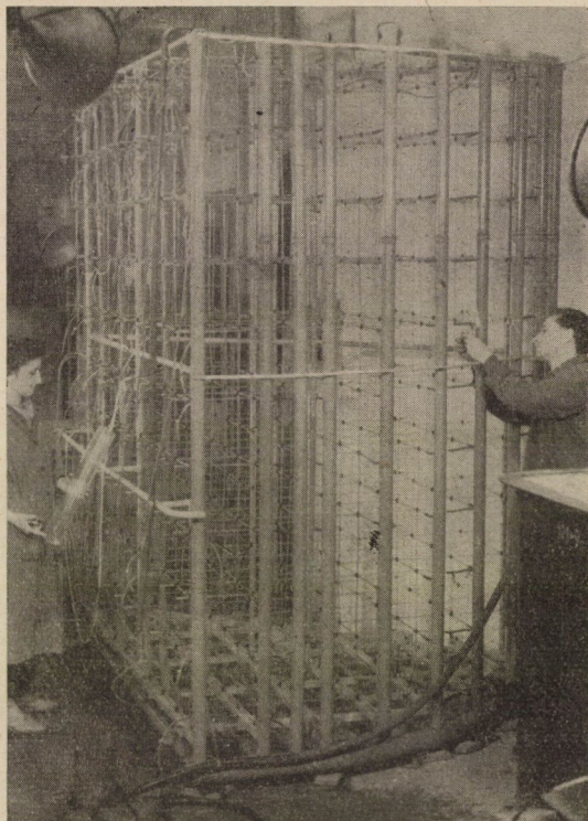
20. ábra. A repedezett kőzetbeli vízmozgás vizsgálatához készült térbeli kisminta
