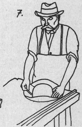
2. á. A pásztorkalap készítésének menete: 1. Gőzölés az avatótűzhelyen. 2. A megavatott fakkok összerakása nemezelés céljából. 3. Az összehajtogatott nemez. 4. Az összehajtogatott nemez foltozása. 5. A pácolt nemez gyúrása. 6. További gyúrás a sodrófával. 7. A kalap formálása.
