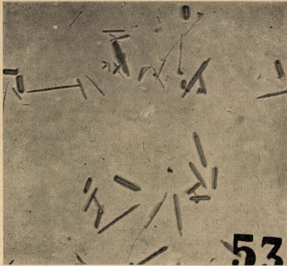
13. ábra. 0,2% mennyiségben Ti-nal és B-ral ötvözött alumínium mikroszöveve ; \times 300
