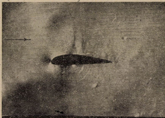
11. ábra. Szokásos szárnyszelvény körül hangon aluli áramlásban keletkező lökéshullámok
