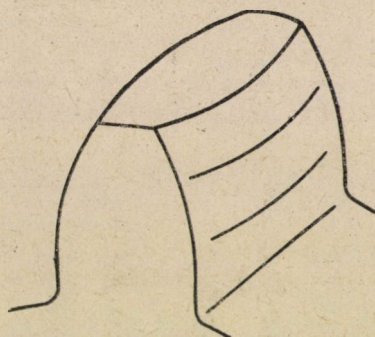
16. ábra. Egyenes fog hordóalakú kiképzéssel
