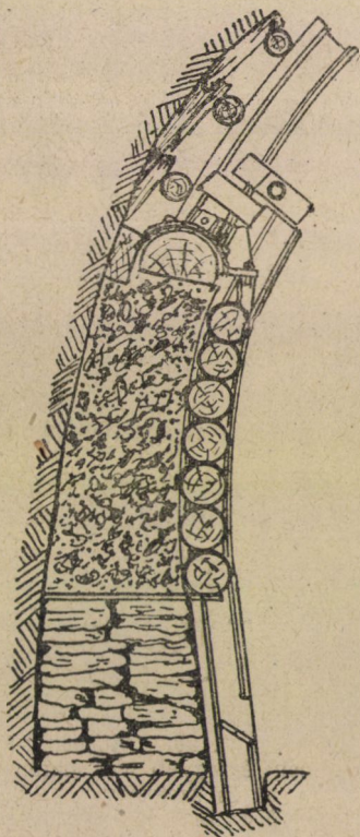
1. ábra. Moll-féle megoldás nagyfokú engedékenység biztosítására
