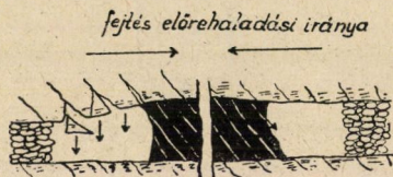
26. ábra. A fővállapok irányának és a fronthomlok előrehaladási irányának a fejtés állékonyságára való hatása
