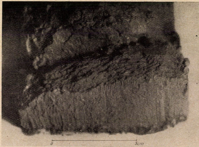
2. kép. Elektromos áram hatására kialakult réteges szerkezet
