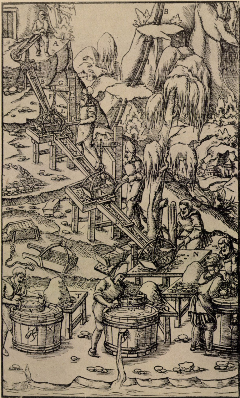
4. ábra A besztercebányai (Urvölgyi) rézérc előkészítése. A) Targoncás, aki a zúzott ércet föladta, B) első surrantó, C) rosta, D) a rosta karjai, E) fogantyúk, F) kötél, G) függesztőkar, H) oszlop, I) második surrantó, K) második rosta, L) harmadik surrantó, M) harmadik rosta, N) első munkapad O) első kéziszita, P) első hordó, Q) második munkapad, R) második kéziszita, S) másdik hordó, T) harmadik munkapad, V) harmadik kéziszita, X) harmadik hordó Y) csapok
