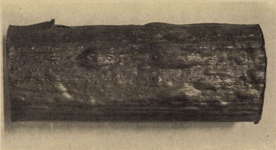
14. ábra. Hólyagos felületű alumíniumbronz cső
