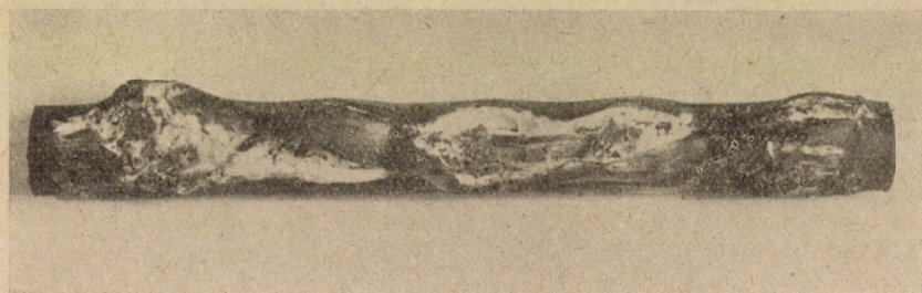
2. ábra. ZnO és fémtörmelékkel kitöltött kidudorodásoktól deformálódott SrA58 rúd
