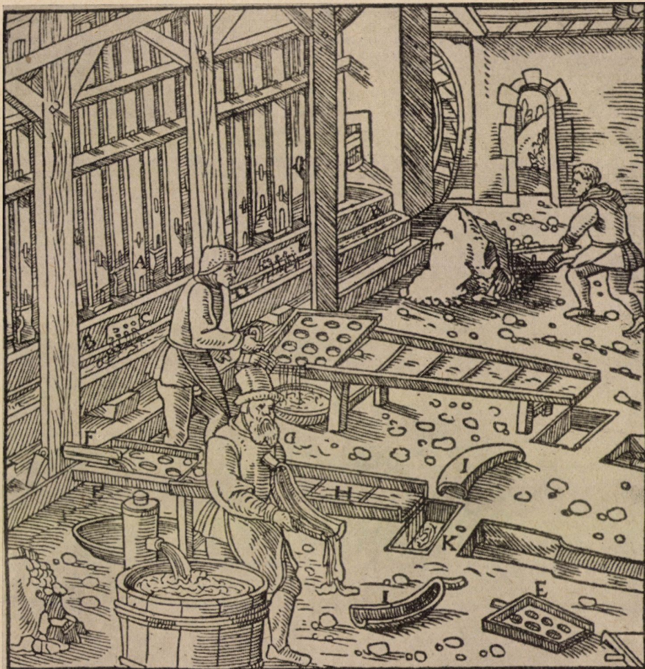
5. ábra. Vízikerekes (minden valószínűség szerint kőrmöci) 20 nyilas zúzó. A) zúzónyilak, B) köpü, C) lyuggatott pléhlemez, D) harántvályú, E) deszkalapok a mélyedésekkel, F) kiöntők, G) teknők, amibe az érc hull, H) síkszerek, I) csolnak alakú kézi szerek, K) a síkszér alatti zsomp
