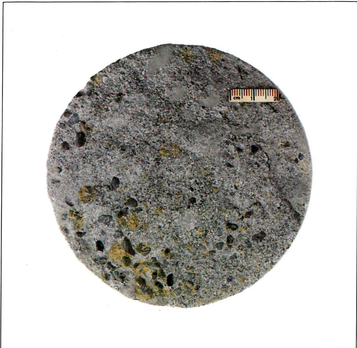
35. ábra. Kvarcirkavics és aleurittörmelék az Egyházasgergei Homokkő Formáció bázisán levő durvaszemű homokkőben (Egyházasgerge 1. sz. fúrás, 20,0 m). Fotó: MÓZER I.
