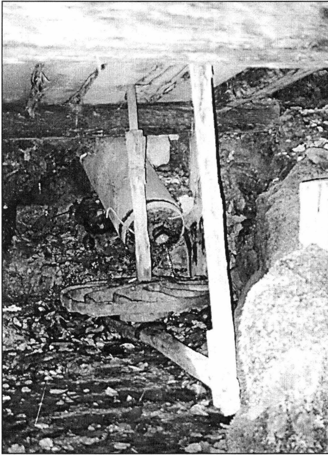
2. kép. Kanalas vízkerék csutorával, tengellyel és a magasságállító szárával. Sichevia (CS), 2000.
