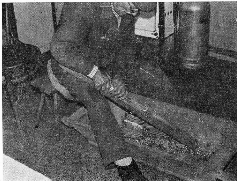
3. kép. A morzsológyalu tartása munka közben
