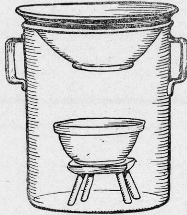
Pálinkafőző készülék. Vorrichtung zum Branntweinbrennen.
