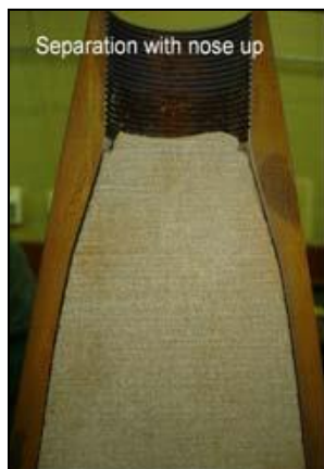
5. ábra: Robbanóanyag test elválása a burkolattól [19]
