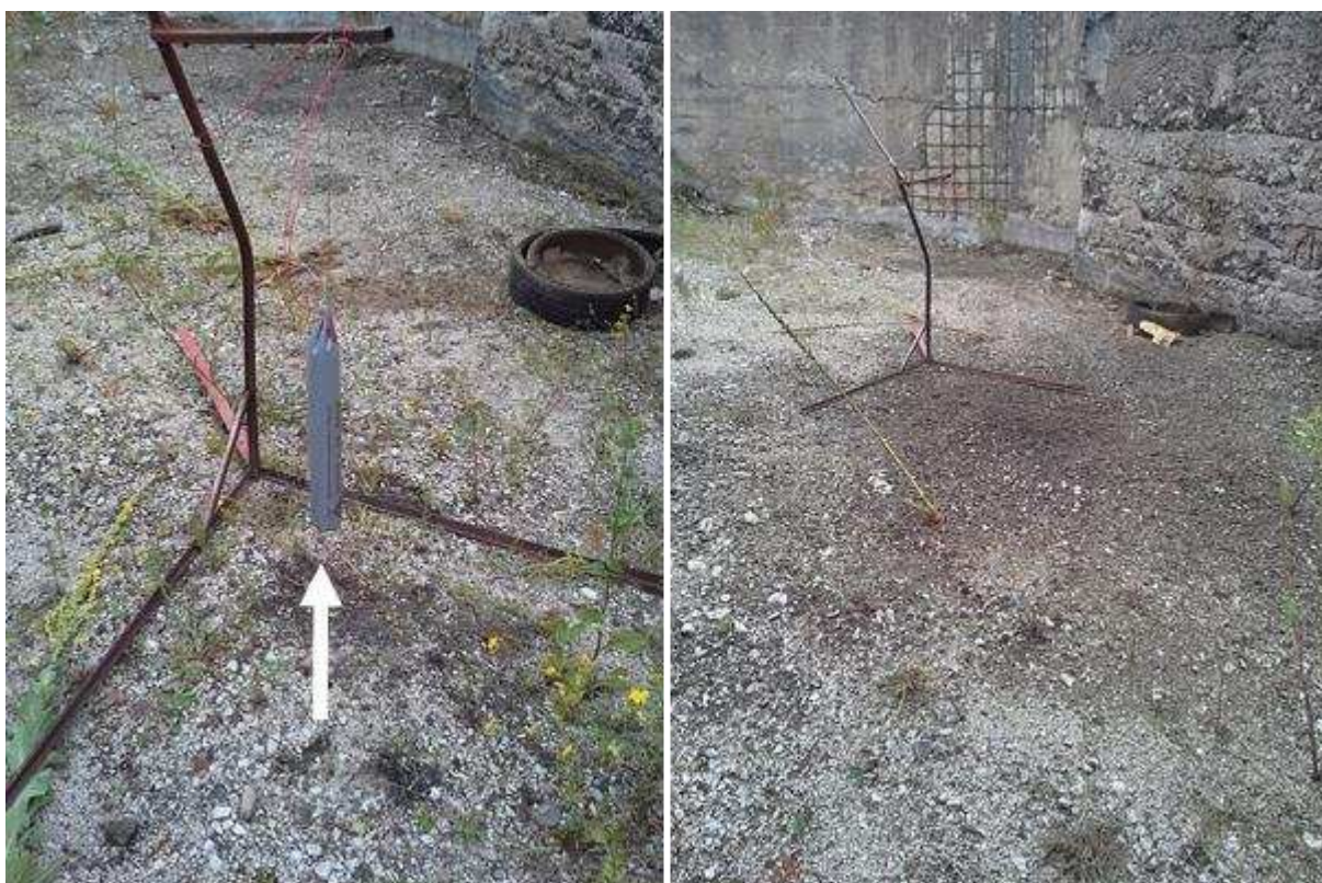
3. A felhasznált robbanóanyag: 2 kg ANDO-ÉV (ammónium-nitrát)
