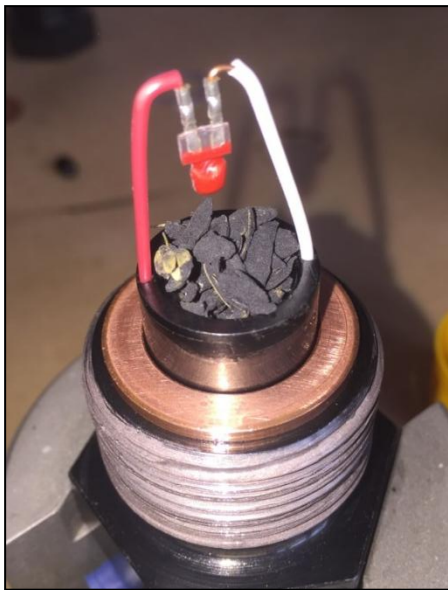
A gersli betöltve vizsgálat előtt, a szakadó membrán felnyílv
