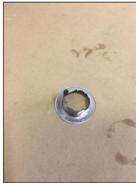
A gersli betöltve vizsgálat előtt, a szakadó membrán felnyílv
