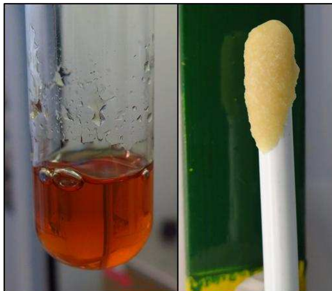
7. ábra: Olvadt TNT és a keverő pálcán megszilárdult Comp-B [8]
