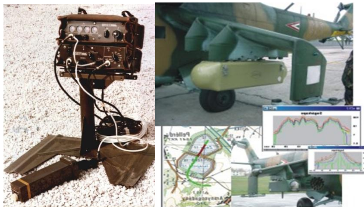
11. ábra Balra az IH-31L légi felderítő rendszer, jobbra az MI-24D helikopterre felszerelt konténer (BNS-89 és NDI/SK detektorral) [13, 14]
