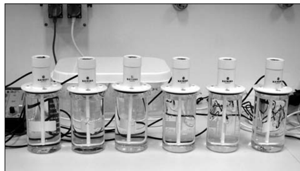
A BME-VKKT laboratóriumában végzett jar-tesztek egy közbelső fázisa: keverést követő ülepítés
