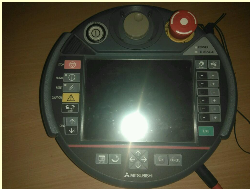
14. ábra Melfa RV-6SD robot kézi vezérlő, programozó (R56TB Teaching box)
