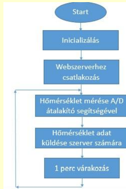
4. ábra Hőmérsékletmérő és adattovábbító alkalmazás működésének folyamatábrája
