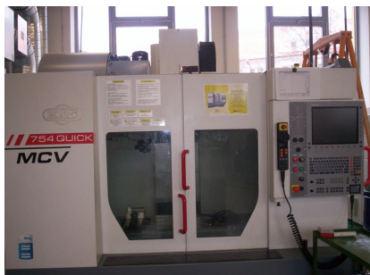
2. ábra: CNC megmunkáló központ Forrás: saját fotó alapján saját szerkesztés
