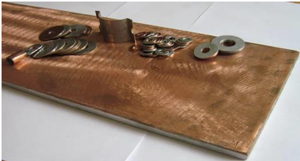
16. számú ábra. Alumínium-réz plattírozott bimetál lemez és a belőle hengerlés után, sajtolással készült alátétek 21
