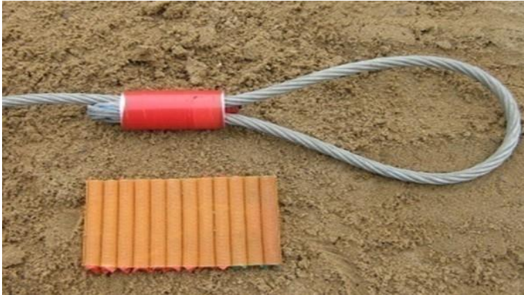
20.számú ábra. Ø12 mm-es drótkötélhurok-készítés alapelemei 31
