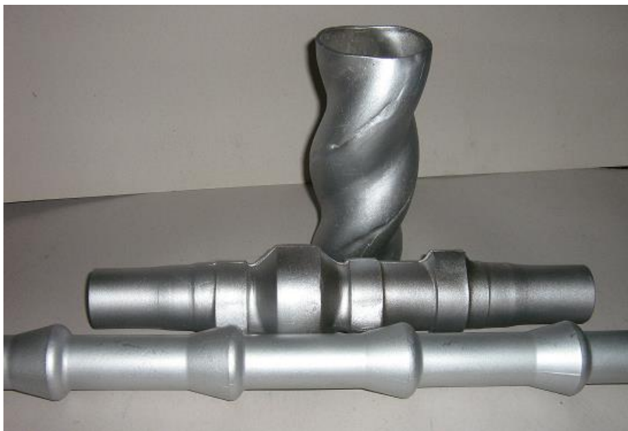
3. számú ábra. Fémcső alakítása robbantással 9
