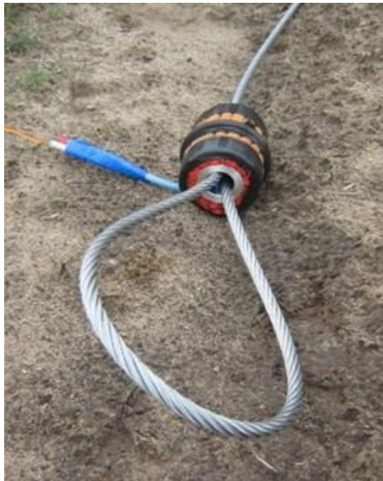
21. számú ábra. Ø12 mm-es drótkötélhurok robbantáshoz előkészítve 32
