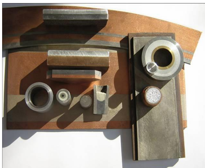
2. számú ábra. Robbantással készített többrétegű munkadarabok 8
