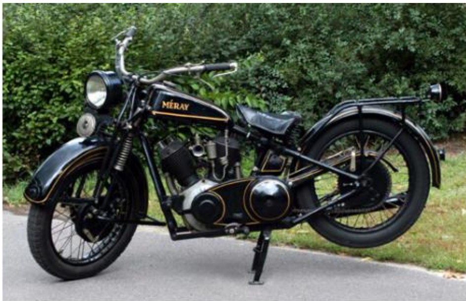
23. ábra. Az 1000-es Méray teljesítménye már lehetővé tette a terepi oldalkocsis-üzemet, ám a hátsó henger hűtésével – nagy terhelés mellett – problémák adódhattak
