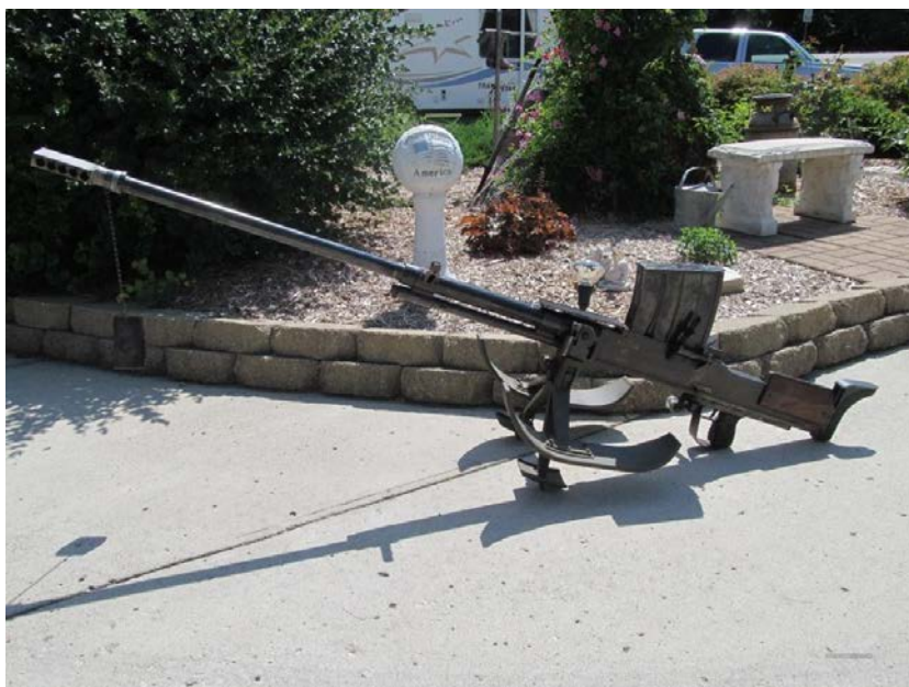
8. ábra. Lahti páncéltörő puska szögletes csőszájfékkel
