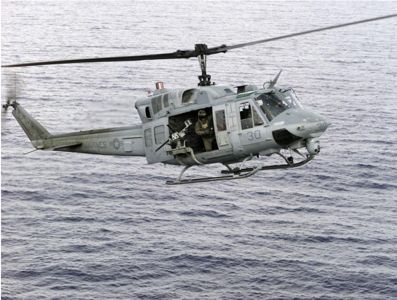
14. ábra. Kéthajtóműves UH-1N a tenger felett. A két hajtómű nyújtotta repülési biztonság-többlet a tenger és a települések feletti repülésnél különösen fontos
