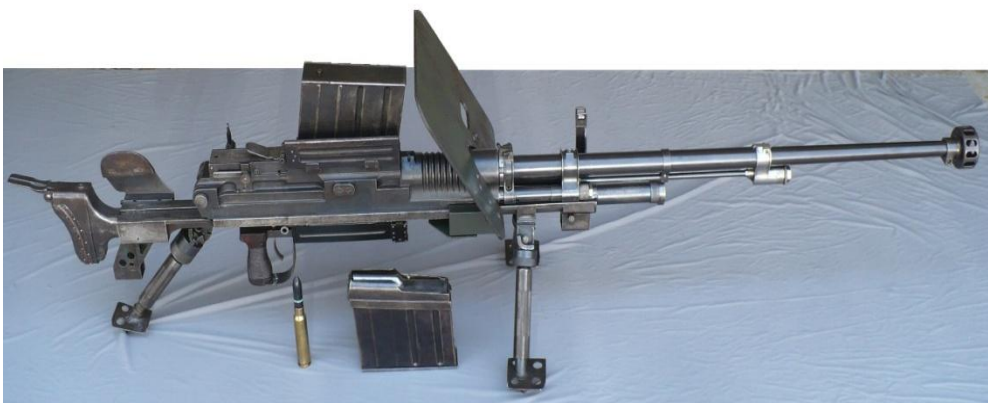
37. ábra. Japán Type 97 páncéltörő puska egy 16 kg-os páncéllemez-pajzssal kiegészítve
