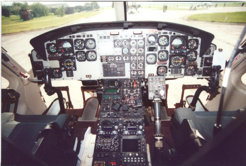
5. ábra. Az UH-1 helikopter műszerfala
