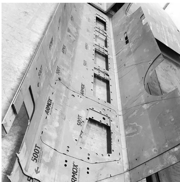
4. ábra. Ballisztikai acél alkalmazása a járműfelépítmény kialakításánál. (8)
