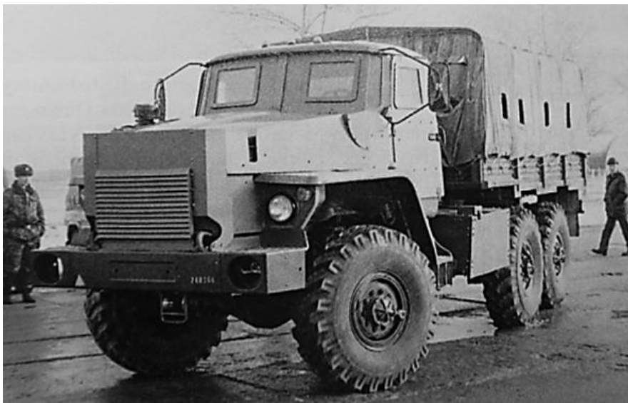
2. ábra. Utólagosan növelt védettségű Ural 4320 terepjáró tehergépkocsi
