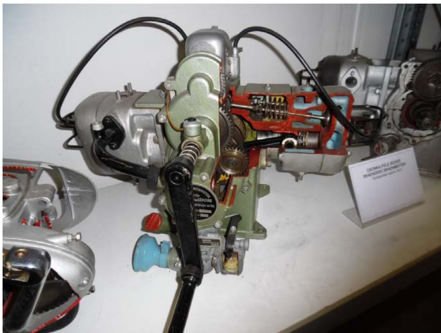
7. ábra. TM-650/2 vízűtéeses boxermotor a Csonka Gépgyárból (Műszaki múzeum)
