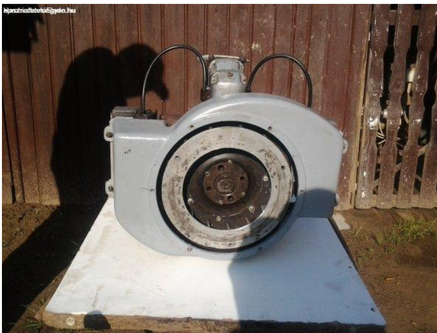
9. ábra. A kényszerléghűtéses boxermotor ventilátora és légtrelőburkolata
