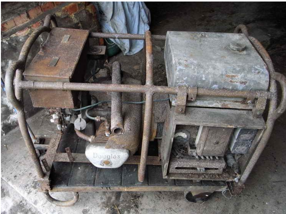
14. ábra. Douglas aggregátor a motorkerékpárával közel azonos motorral
