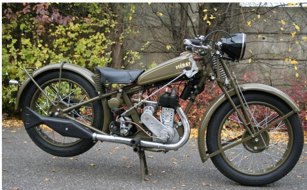
25. ábra. A Magyar Királyi Honvédség számára gyártott Méray motorkerékpár 350-es egyhengeres JAP motorral (oldalkocsis üzemhez nem rendelkezett megfelelő teljesítménnyel és nyomatékkal)
