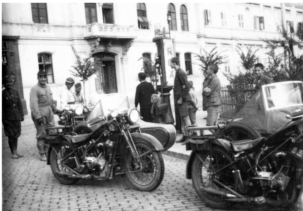
24. ábra. 1000-cm 3 hengerűrtartalmú 22 LE-s JAP motorral szerelt Méray motorkerékpár oldalkocsival 1933-ból (Fortepan)
