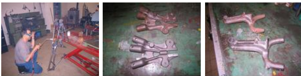
27. ábra. Méray motorkerékpár vázának és csomóponti vázöntvényeinek előállítása egy hazai motorkerékpár-építő műhelyben
