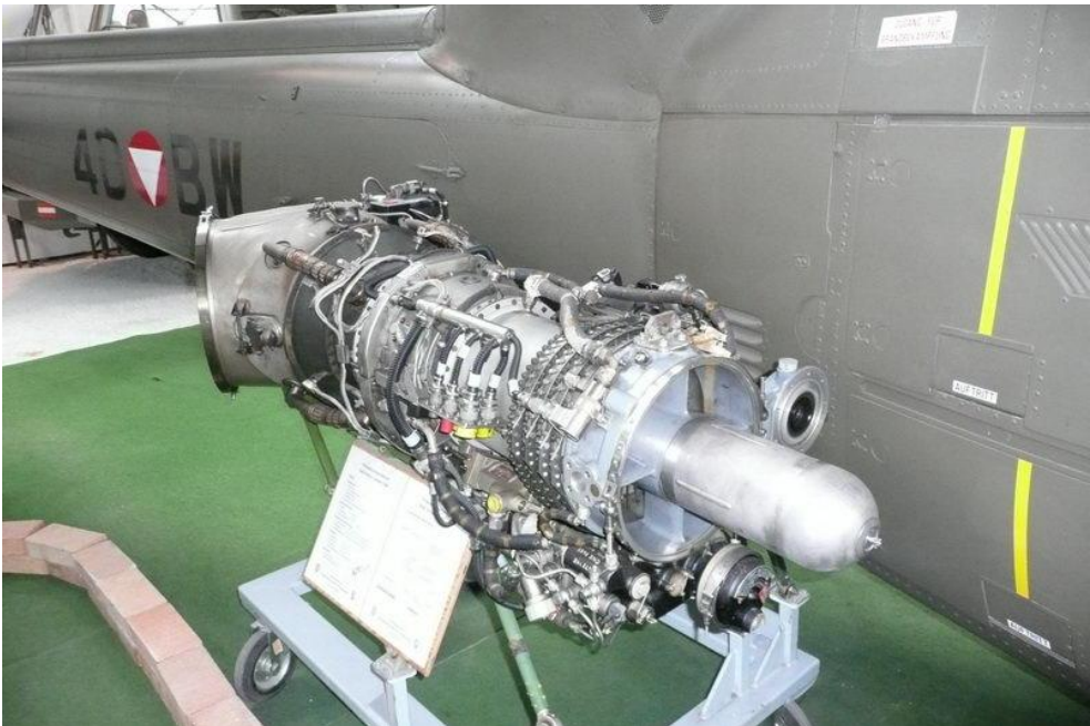
3. ábra. Az UH-1 helikopter Lycoming T-53-L-1A gázturbinás hajtóműve
