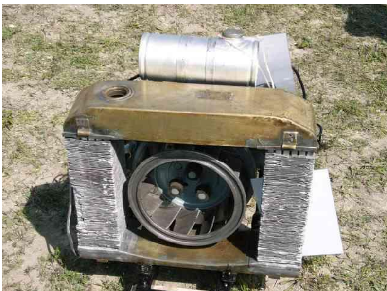
10. ábra. A vízhűtő kialakítása a TM-650/2 boxermotoron
