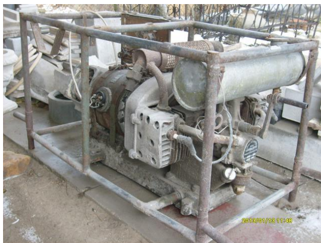
7. ábra. Felújításra váró Csonka-aggregátor a háború után beépített generátorral
