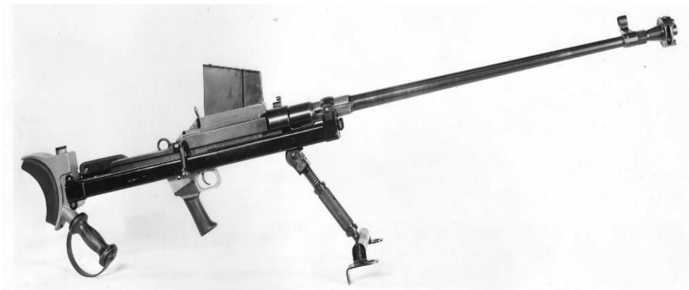
1. ábra. Brit Boys páncéltörő puska villaállvánnyal és csőszájfékkel
