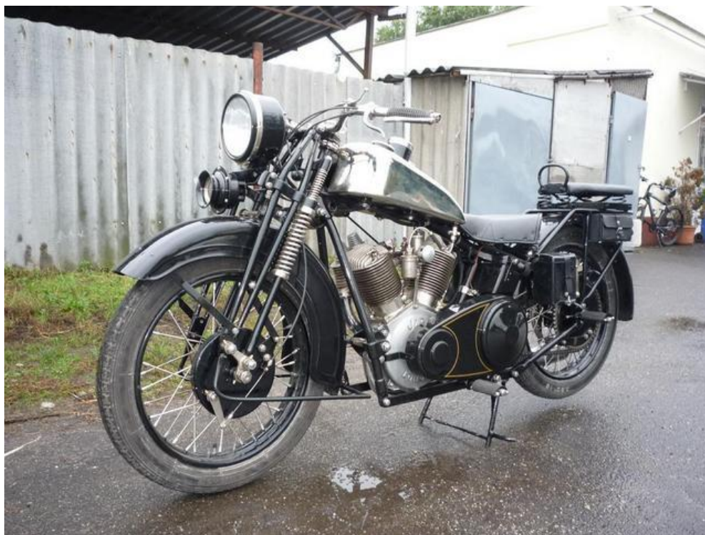
18. ábra. Méray motorkerékpár brit eredetű JAP V-motorral, 1936
