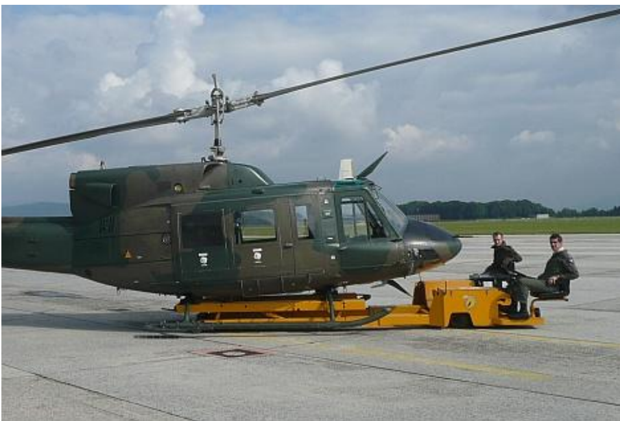
11. ábra. Az UH-1N olasz változata, az AB-212. A merevfutós helikopter földi mozgása speciális eszközt (pl. elektromos szállítókoszt vagy kerekes vendégfutót) igényel
