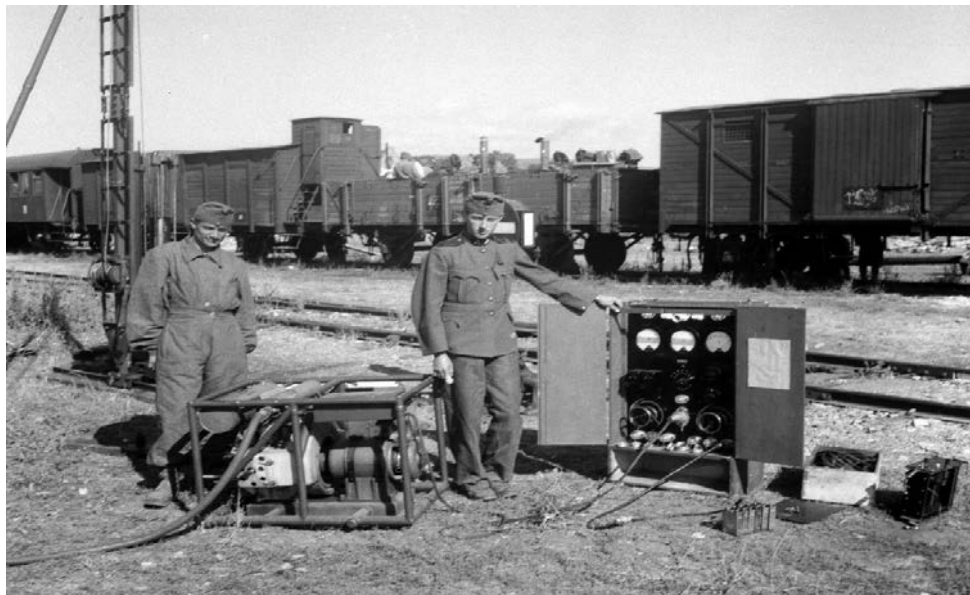
5. ábra. A 30M Csonka - aggregátor a Magyar Királyi Honvédség alkalmazásában. A kipufogóra erősített hajlékony cső a füstgázok elvezetése mellett részleges hangtompítást is végzett
