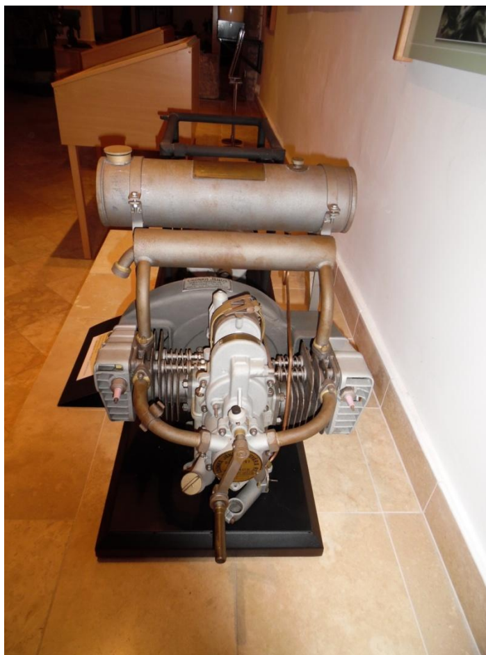
1. ábra. 1927-től gyártott boxer elrendezésű léghűtéses Csonka aggregátor-motor a Csonka múzeumban, még nyitott szelepemelő-rudazattal
