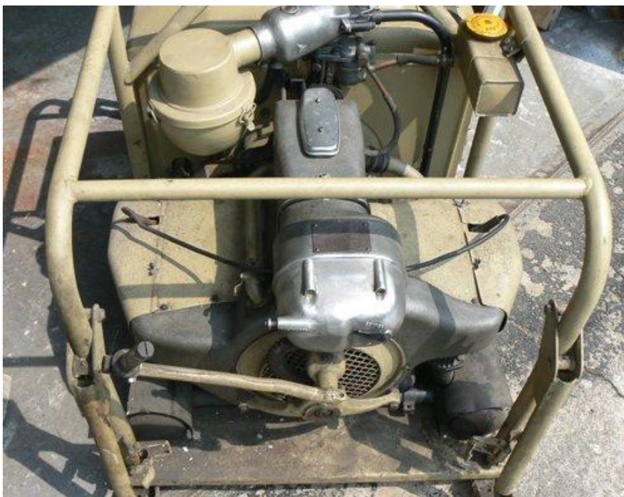
17. ábra. Német gyártmányú 600 cm 3 -es boxermotoros aggregátor (Stromaggregát: áramaggregátor) a II. világháborúból
