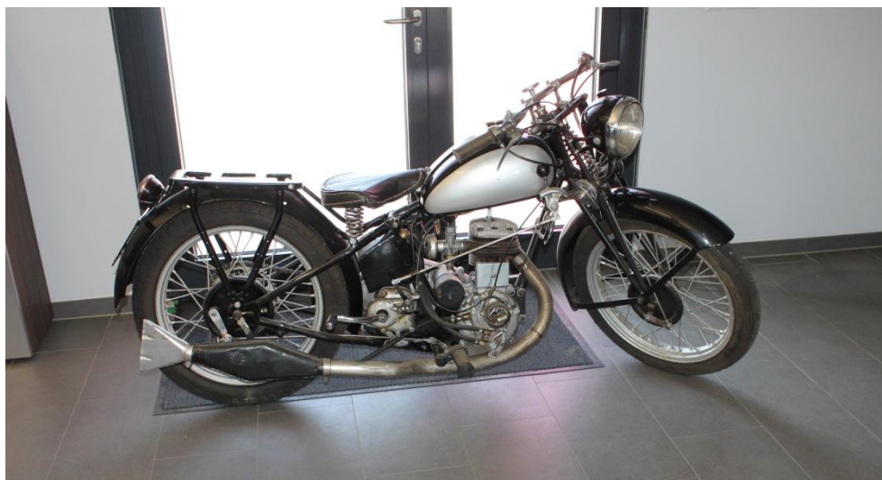
20. ábra. Hazai gyártású egyhengeres Csonka motorral szerelt Méray Mara 350 SV motorkerékpár (Maróti gyűjtemény)
