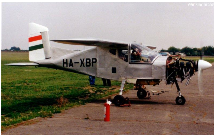
4. ábra. A GAK-22 Dino repülőgép motorburkolat nélkül. Látható a Lycoming O-235 H2C négyhengeres, léghűtéses, benzinüzemű boxer elrendezésű repülőgépmotor
