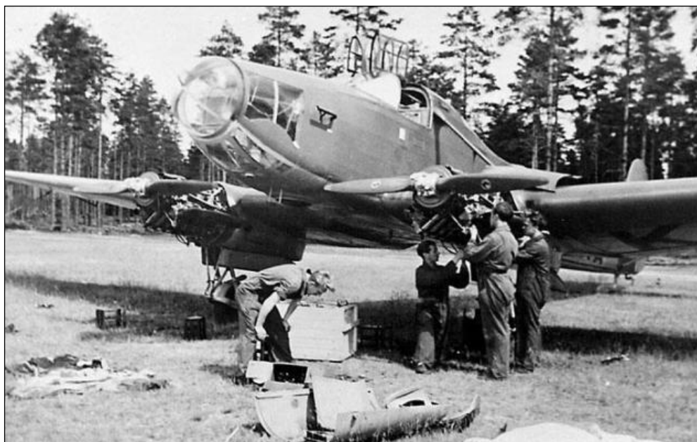
5. ábra. Az Argus As10-es motorok fordított „V” elrendezése lehetővé tette, hogy a motor kiszolgálását és javítását állványok nélkül is el lehessen végezni
