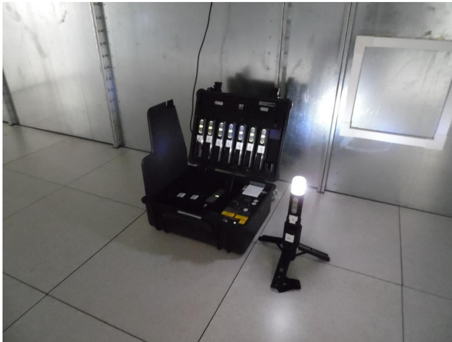
14. ábra. A TALKIT teljes készlete a bőröndben töltődik, egy fényelem kiemelve, a saját tripodján önállóan működtetve
