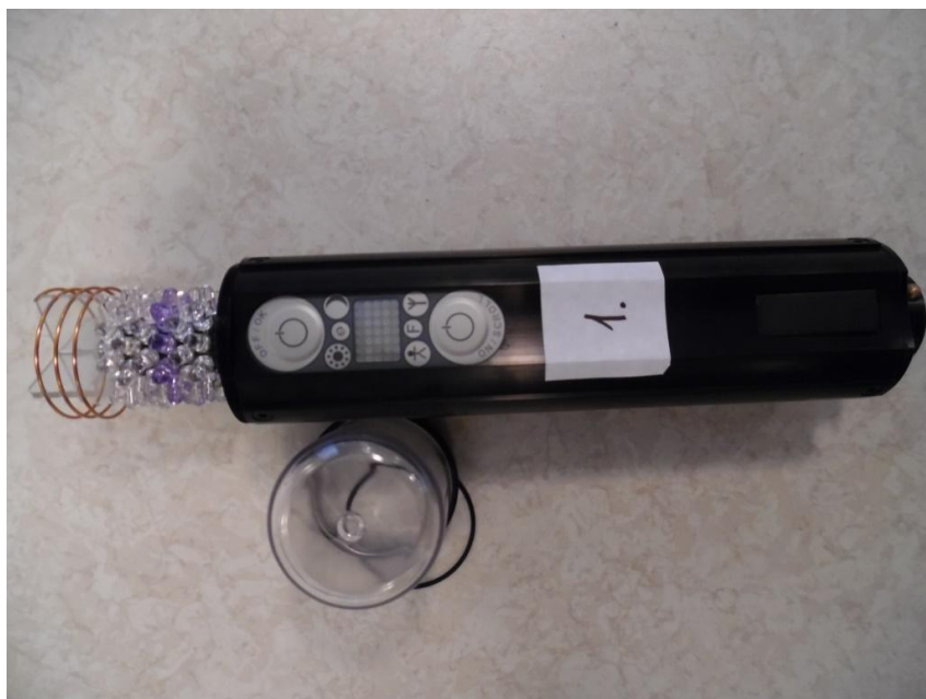
15. ábra. Egy fényelem leszerelt üvegburával. Az alumíniumház 80%-át az akkumulátor foglalja el. A több eltérő szín miatt a LED-csoport diszkrét fénydiódákból van felépítve. Legfelül található a rádióvezérlés vevőantennája
