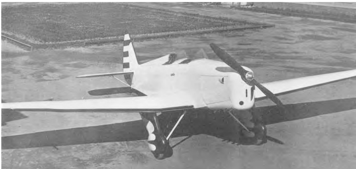
2. ábra. Egy korai UT-2 soros elrendezésű léghűtéses Renault motorral
