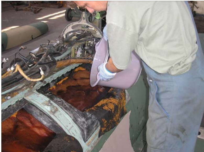
10. ábra. Üzemanyagtartály műgyantával történő feltöltése a repülőtechnikai eszközök hatástalanítása során
