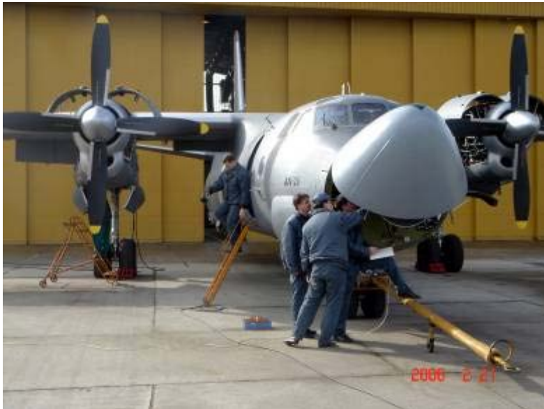
8. ábra. An-26 időszakos ellenőrzési munkálatai
