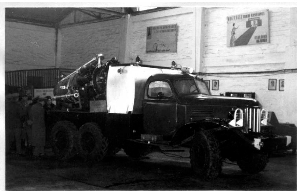
2. ábra. Az algyői tűzoltóság számára kifejlesztett speciális tűzoltó jármű
