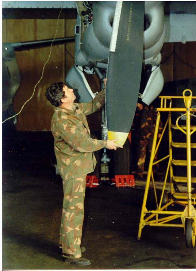
4. ábra. Légcsavarlapát ellenőrzése An-26 típusú repülőgépen
