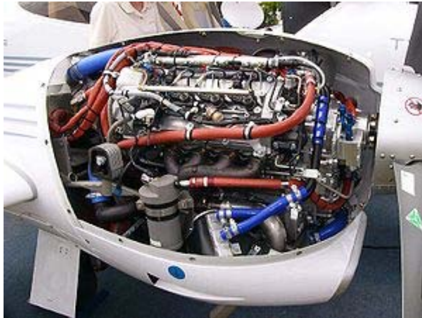
1.ábra. DA-42 könnyű repülőgépbe épített 1,7 liter lökettérfogató dízelmotor
