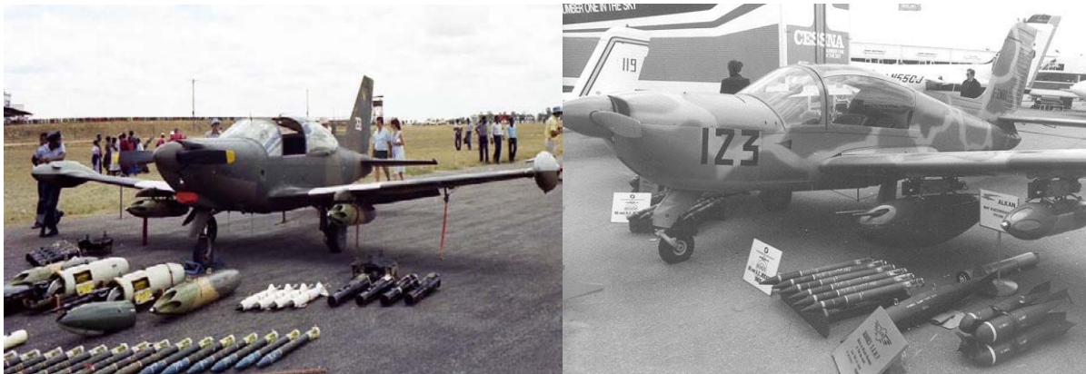
3. ábra. A olasz Marchetti SF-260C és a francia Socata Rallye 235 felfegyverzési lehetőségei
