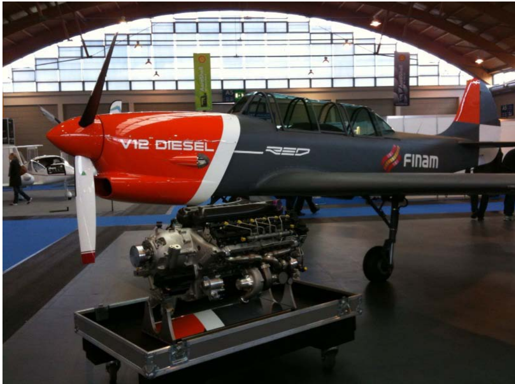
13. ábra. Audi eredetű Raiklin RED-3 500 lóerős repülőgép dízelmotor egy Jak-52-esben
