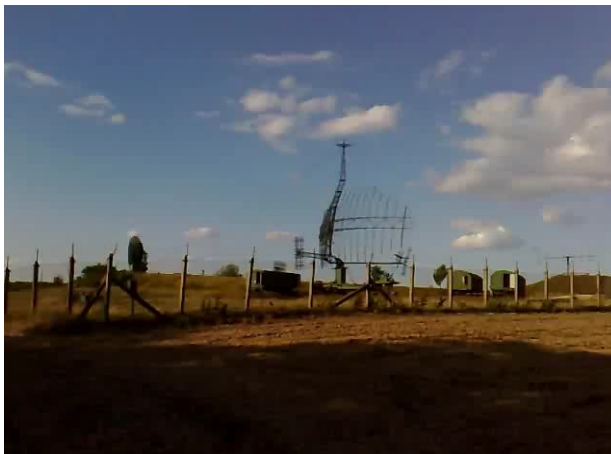
1. ábra. Közepes teljesítményű „m”-es vagy „VHF” radar
