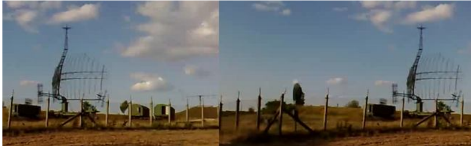
14. ábra. Iker VHF radar koncepció hagyományos hardvereken
