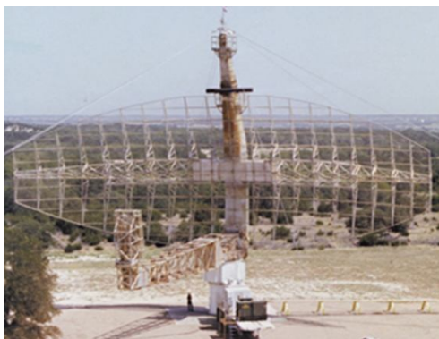
2. ábra. Lincoln Laboratórium VHF teszt radarja
