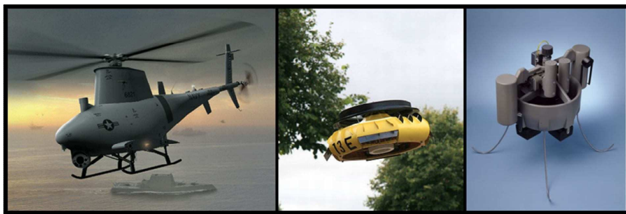
4. ábra Egy főrotoros UAV típusok Balról jobbra: Fire Scout 7 , GFS Project 8 , T-Hawk 9 ,
