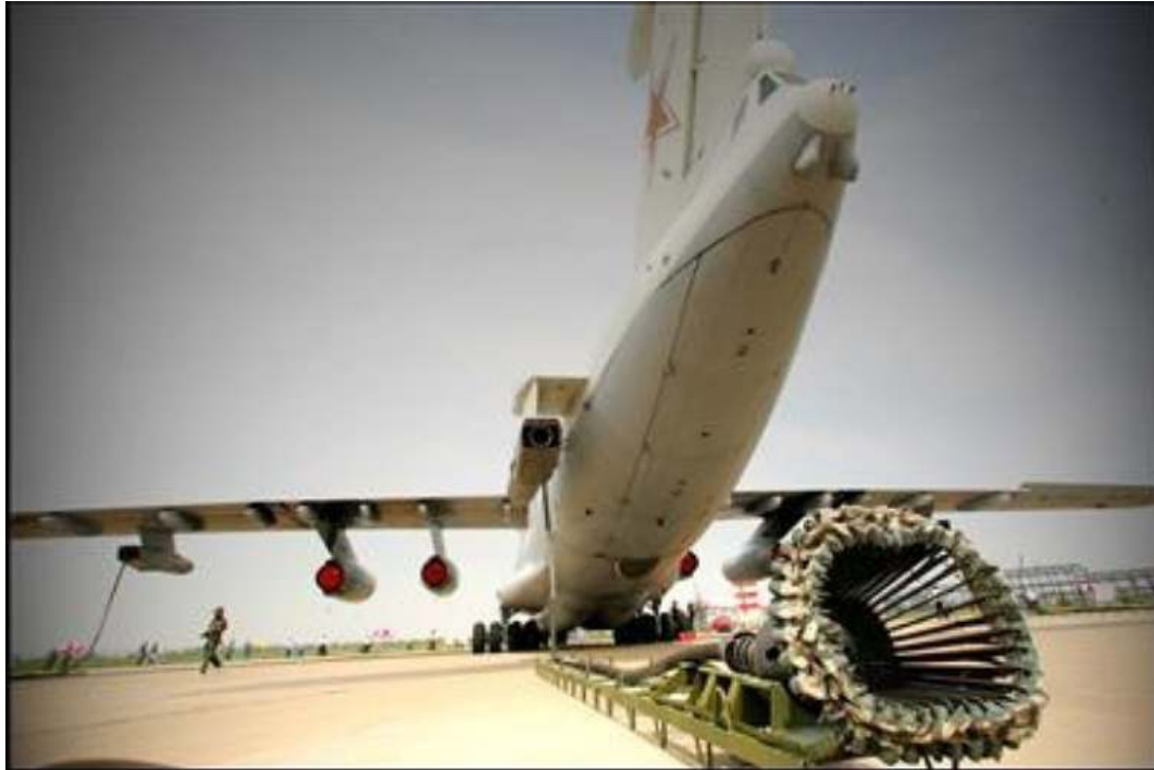
1. ábra Il-78M kosaras légi utántöltő berendezése
