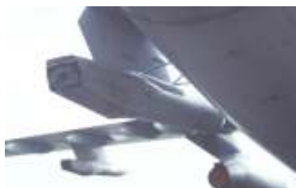
4. ábra Il-78-as farok alatti UPAZ-1A konténer
