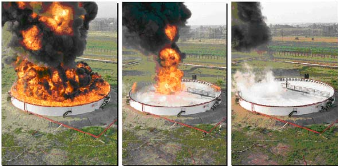
6. ábra: A tűzoltási próba alkalmával az 500 m 2 felületű benzintűz 25 másodperc alatt került eloltásra.
