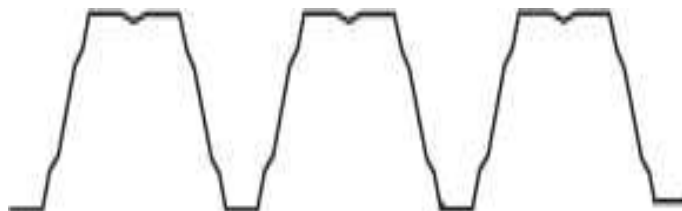
1. ábra. Magashullámú trapézlemez jellemző keresztmetszete
