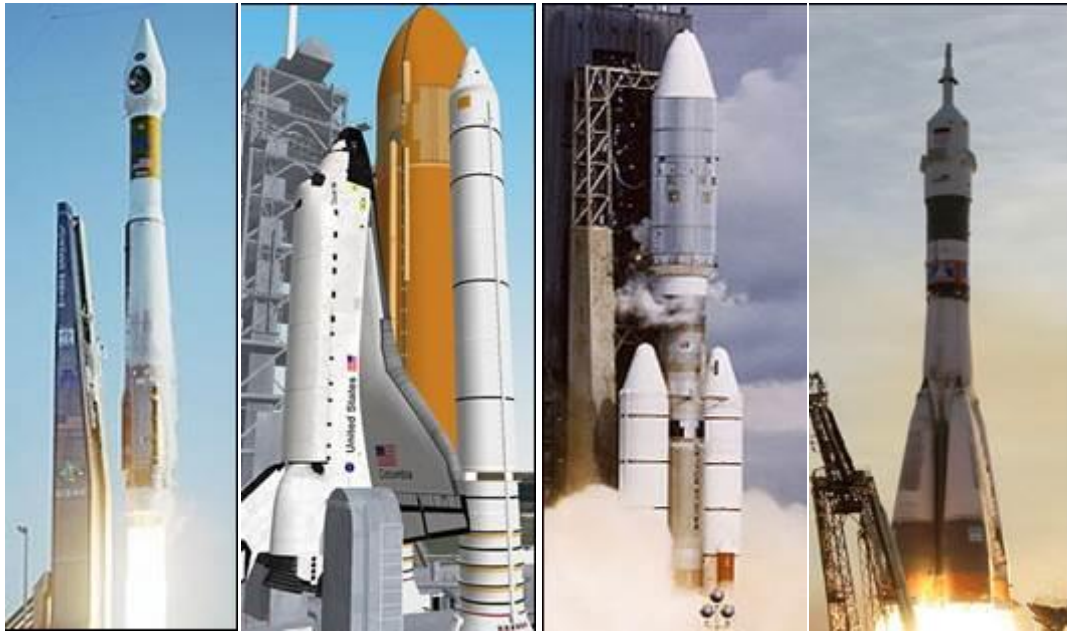
15. ábra: A példaként jelölt soros, párhuzamos és vegyes felépítésű rakéták. Balról jobbra haladva: Atlasz, Space Shuttle, Titán, Szojuz (MSZ-archív)
