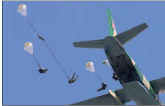
11. kép. OVP-80.08 típusú légideszant ejtőernyő An-26 típusú szállító repülőgép rámpájáról történő, stabilizátoros nyitási rendszerű ugrás végrehajtása során [31]. A képen jól megfigyelhető a második ugró ejtőernyője nyílási folyamatának „jóval előrehaladottabb” állapota társaihoz képest 25 .
