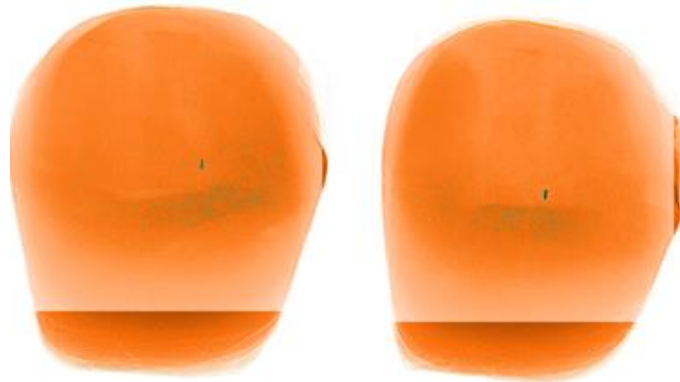
17. ábra. Szögfej élével elhelyezve egy 20 kg-os zsákban, jól láthatóak körülötte a milliméternél is kisebb szennyeződések (Kálmán)
