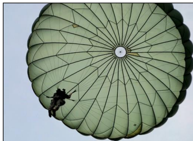
2. kép. A T-10A típusú ejtőernyő a levegőben [17] A kupola belépője alatt jól megfigyelhető az ún. „antiinverziós háló”.
