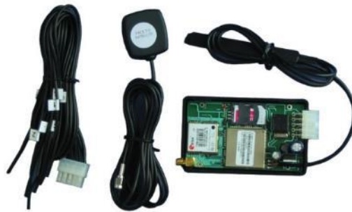
4. ábra. Egy GPS-eszköz antennákkal és vezetékkel Baloldalt: vezeték a jármű elektronikájához, középen: GPS antenna, jobboldalt: az eszköz a GSM antennával [9]
