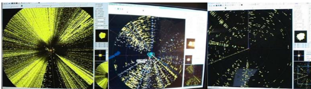
5. ábra. Aktív zajzavar, aszinkron és szinkron válaszimпульzus-zavar az SzT-68U/M 16 képernyőjén [13]
