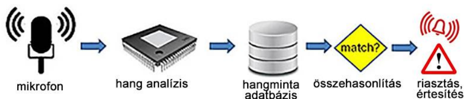
3. ábra Drónhang észlelés és feldolgozás folyamata [15]
