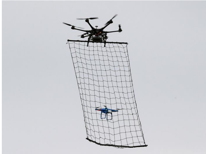
1. ábra A hálókilövő drónelhárító drón [11]
