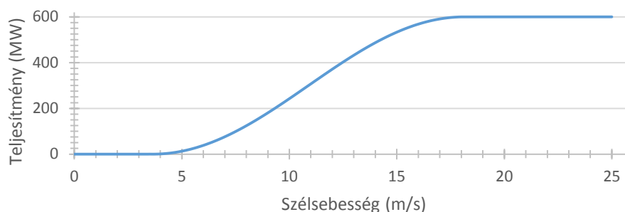
13. ábra A kulcsi szélérőmű (Enercon E-40) jelleggörbéje [35]
