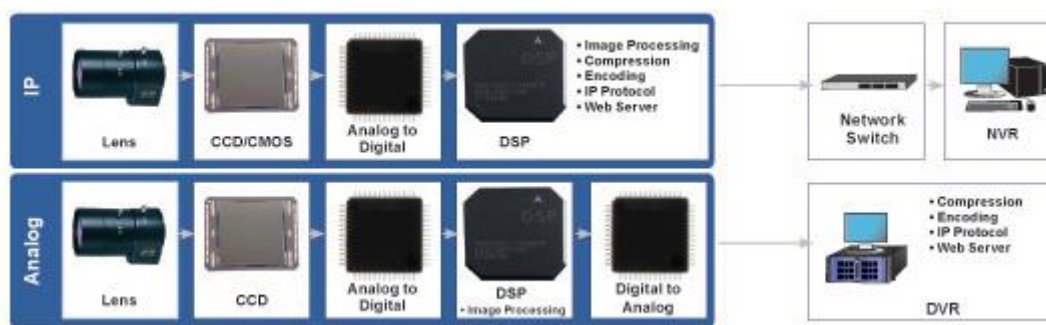
1. ábra. Az analóg és az IP kamerák felépítése [1]
