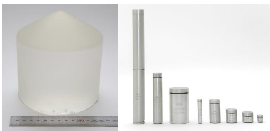
2. ábra NaI(Tl) szcintillációs kristály képe tokozással és nélküle. [2]
