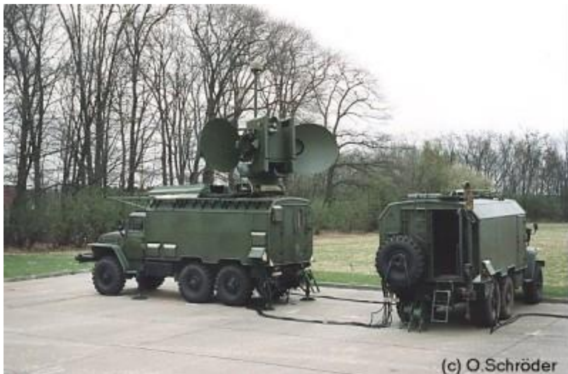
7. kép. Az SZPN-30 repülőgép-fedélzeti rádiólokátor zavaró komplexum. [34]
