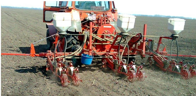
1. Ábra. Vetés menete precíziós vetőgéppel Forrás: saját felvétel
