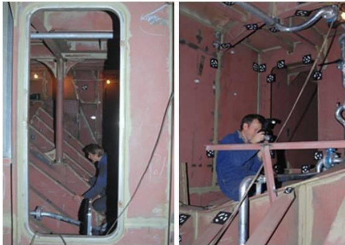
2. ábra: Sarokpontok meghatározása hajótestben [3]
