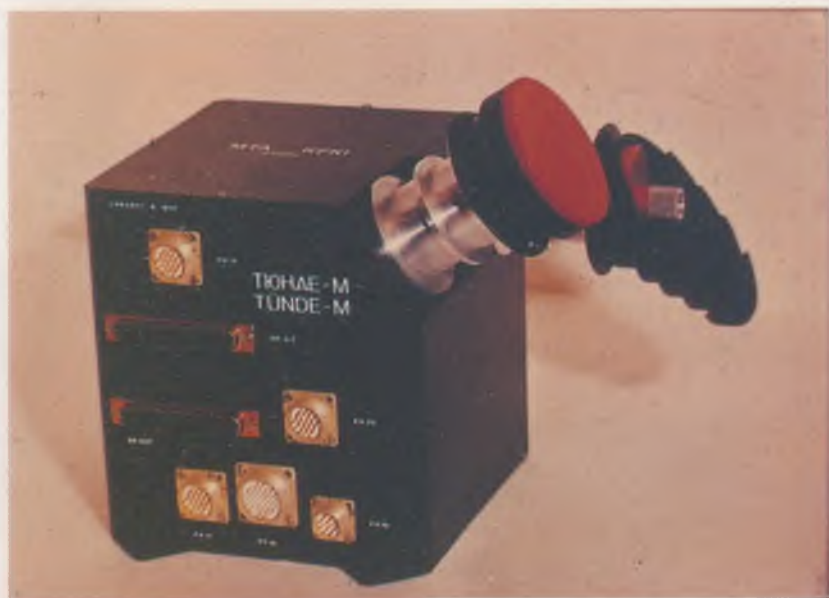
7. kép. A Vega Halley-szonda Tünde jelű kozmikussugárzás-detektora. Elektronikáját a KFKI-ban készítették
