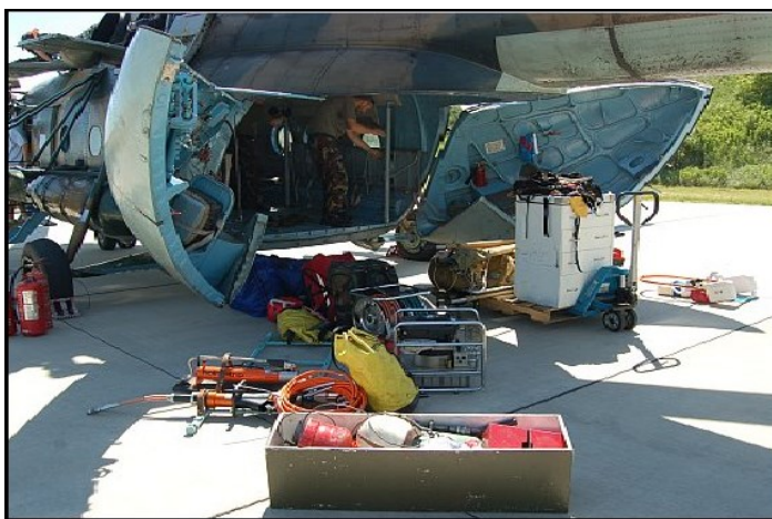
8. sz. ábra: A kutató-mentő felszerelés beépítése a MI-17-esbe Készítette: Szórád Tamás 25
