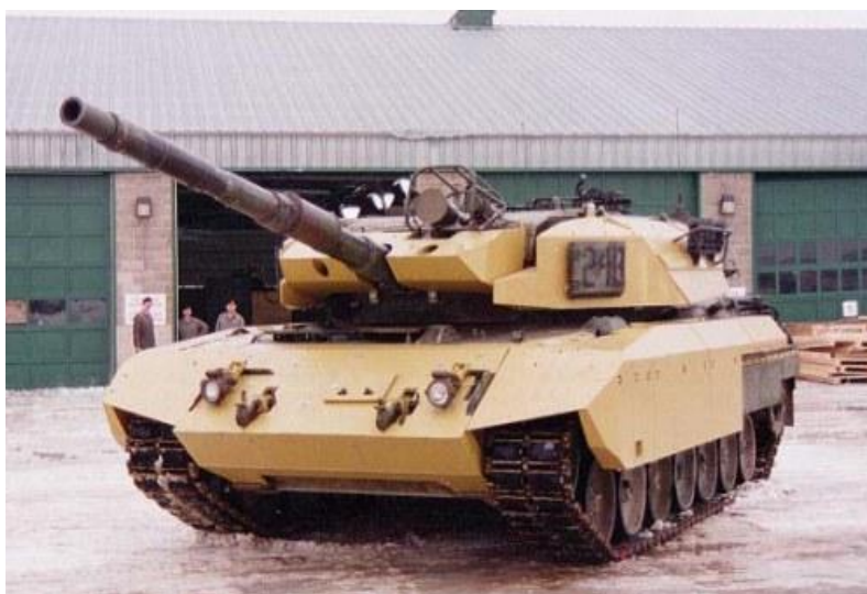
5. Kép: Leopard-1 harckocsi utólag felszerelt kiegészítő páncélzattal 5
