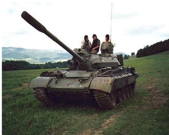
4. Kép: Korszerűsített T-55 harckocsi, a torony előtét, a homlokpáncélon kiegészítő páncélzattal 4
