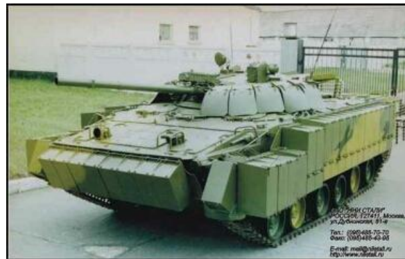
8. Kép: BMP-3 harcjármű „Kaktus” ERA-val felszerelve 21
