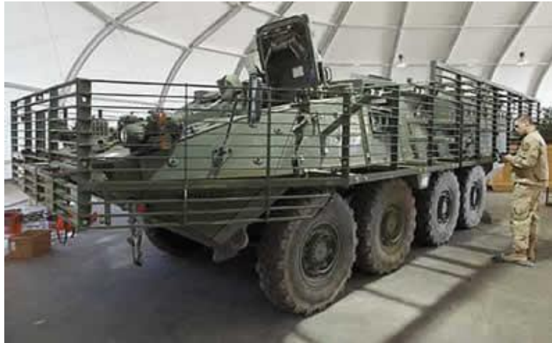
9. Kép: Stryker harcjármű „ketrec” kiegészítő páncélzattal 10
