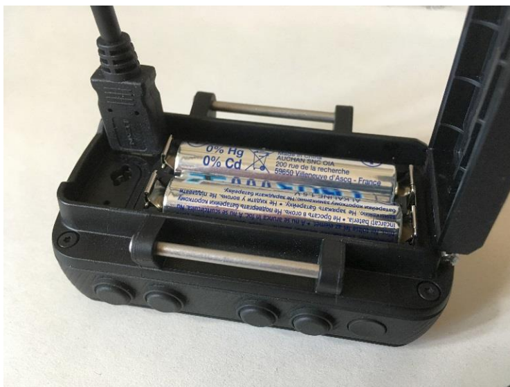
4. ábra: Vízálló burkolat alatt az energiaforrás (2 db AAA típusú elem) és az adatkommunikációs bemenet
