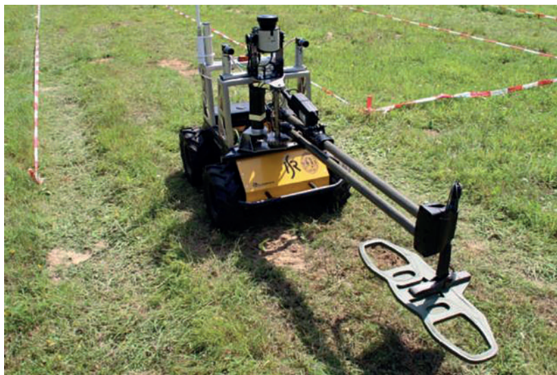
12. ábra. A Tiramisu amerikai aknafelderítő robot
