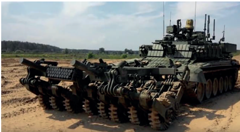
13. ábra. Az orosz Prokhod-1 aknamentesítő rendszer
