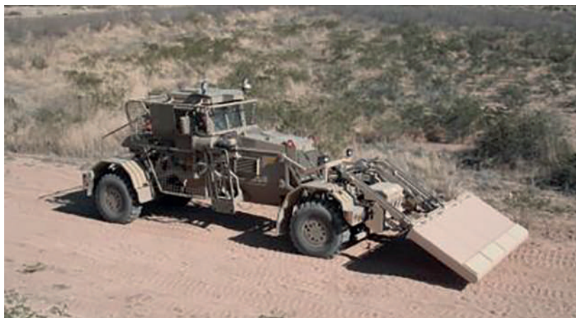
11. ábra. A Husky-2 amerikai aknakutató gépjármű
