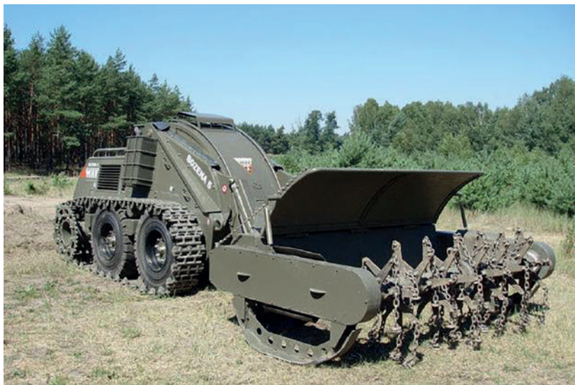
14. ábra. A Bozena-5 kalapácsos aknamezítő rendszer
