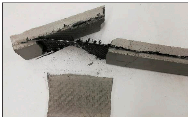
15. ábra: Szövet erősítésű próbatess tönkremenetele
