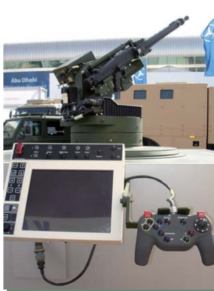
JÁRMŰRE ÉPÍTHETŐ ÁLLVÁNY A HASZNÁLATÁHOZ SZÜKSÉGES KÉPERNYŐVEL ÉS VEZÉRLŐEGYSÉGGEL
