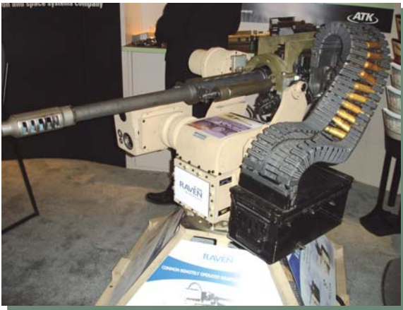
SZINTÉN JÁRMŰRE SZERELHETŐ ESZKŰZ, MELYEN AZ OPTIKAI BERENDEZÉSEKET PÁNCÉLOZÁSSAL VÉDETT MÓDON HELYEZTÉK EL
