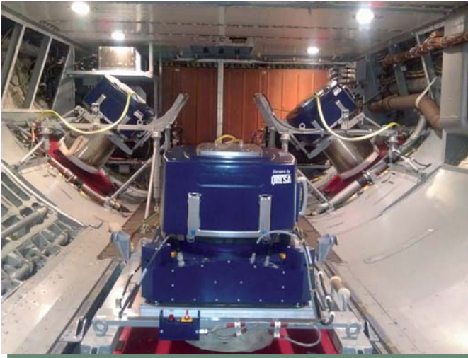
AZ OROSZ TU-214ON NYITOTT ÉGBOLT MEGFIGYELŐ REPÜLŐGÉP SZENZORJAI: ANALÓG ÉS DIGITÁLIS KAMERÁK...
