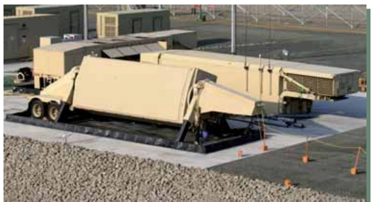
3. KÉP BALLISZTIKUS RAKÉTÁK ÉSZLELÉSÉRE SZOLGÁLÓ AN/TPY-2 TÍPUSÚ MOBIL RADAR-RENDSZER →
