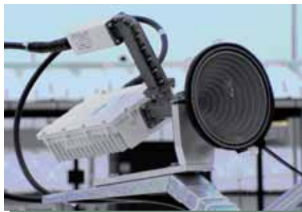
8. ÁBRA Ku SÁVÚ ADÓERŐSÍTŐ (ALUL) ÉS VEVŐERŐSÍTŐ (FELÜL) (FORRÁS: A SZERZŐK SAJÁT ARCHÍVUMÁBÓL)
