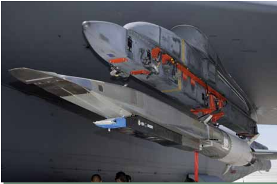
4. KÉP Egy B-52-es szárnya alatt felfüggesztett Waverider hiperszonikus pilóta nélküli repülőgép
