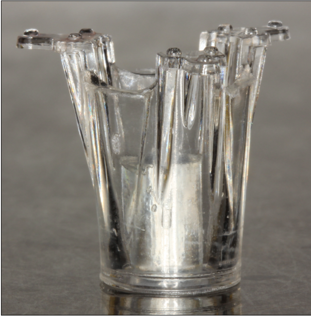
3. kép: Millicell inzerbe helyezett MED610-ból nyomtatott henger
