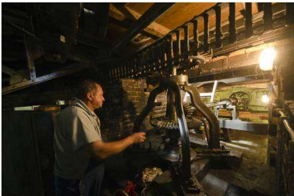
A Vidámpark egyik legrégebbi játéka, a valószínűsíthetően 1906 óta üzemelő körhinta alatti szerkezet
