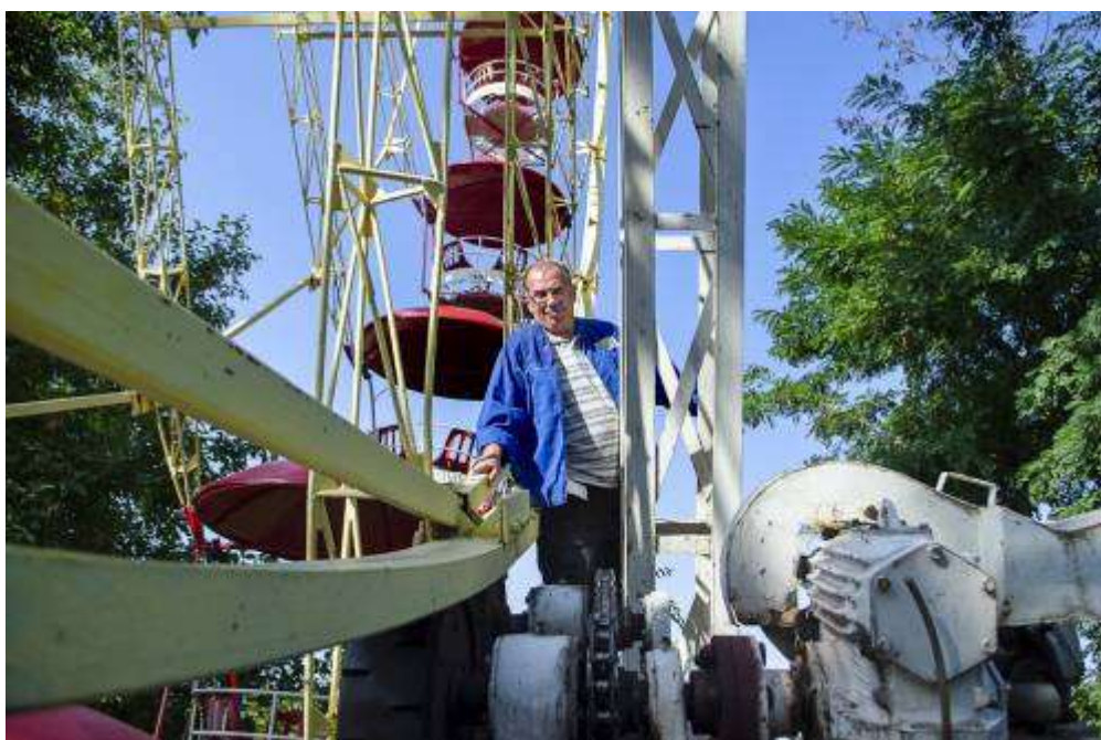
A 31 méter magas, 1974-ben üzembe állított Óriáskerek mozgató motorja
